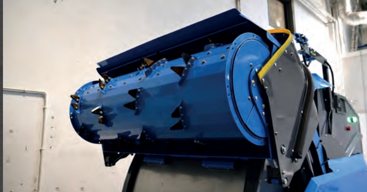
Fresa que realiza la autocarga en la parte frontal de la máquina
