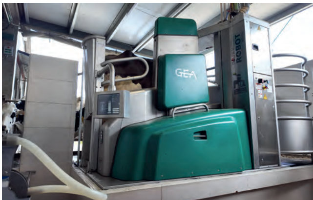
“Elixín GEA polo foso, a separación por cuartos e a colocación manual”
