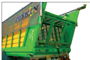
• Pared frontal reclinable (ayuda a la descarga)
