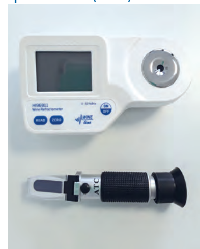
Figura 5. Refractómetros dixital (arriba) e óptico ou manual (abaixo)
