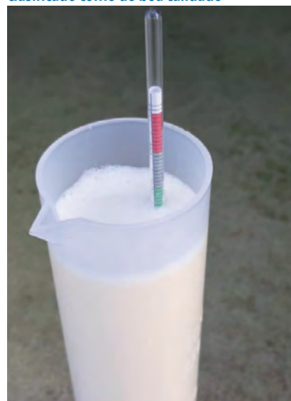
Figura 4. Costrómetro flotando nun costro clasificado como de boa calidade
