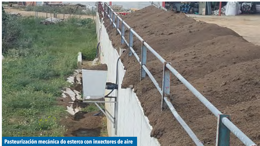
Pasteurización mecánica do esterco con inxectores de aire
