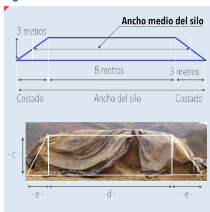
Figura 2. Silo recién hecho visto de frente
