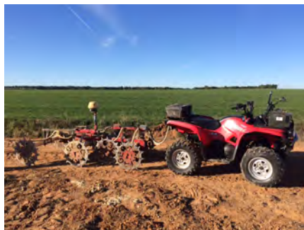
Quad con antena GPS e medidor de resistividade
