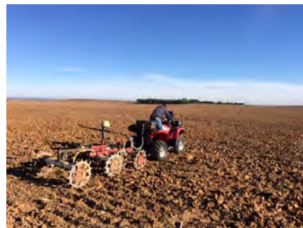
Quad con antena GPS e medidor de resistividade 1
