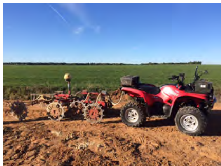
Quad con antena GPS y medidor de resistividad
