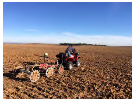
Quad con antena GPS y medidor de resistividad 1
