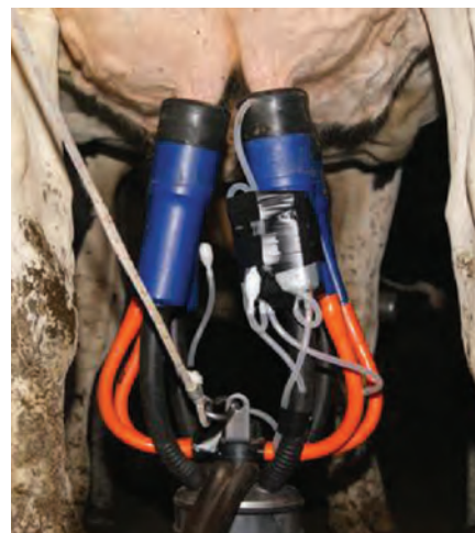
Figura 8. Realización do test do tempo de muxido cun sensor de catro canais colocado na unidade
