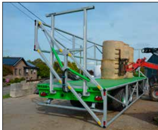
Escalera frontal reforzada
