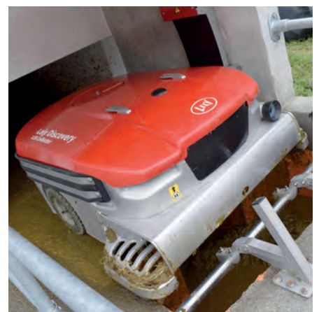
El Lely Collector permite elegir el punto de descarga
